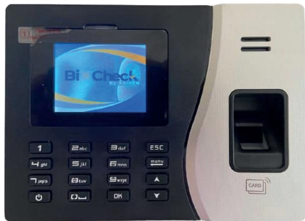
Los dispositivos biométricos de última generación ASIVEN, tienen la capacidad de alimentación con tecnología Power over Ethernet (PoE), conexión a la red eléctrica 110v y posee una batería recargable que garantiza su operación ante caídas temporales del servicio eléctrico.
